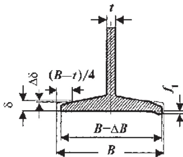
Схема за извършване на измерването на стойността на износване и огъване на монорелса за проверяване на дефекти
